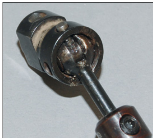
Diese stark verschlissene Kardanwelle zeigt ein Problem, das auftritt, wenn sich Schmierfett und Sand vermischen. Das Resultat ist eine regelrechte Schleifpaste
